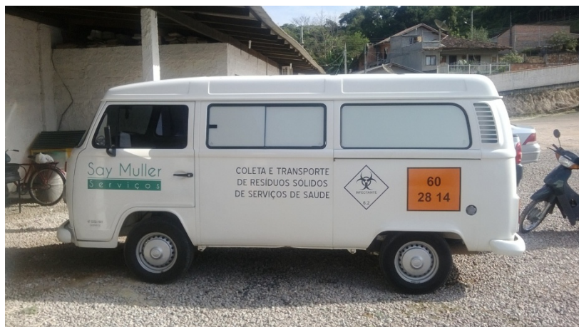
Figura 1 – Veículo sinalizado com rótulo, símbolo e número de risco, segundo NBR 7.500 da ABNT (2003).
