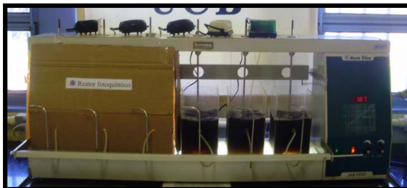
Figura 2: Equipamento Jar Test modificado para reator fotoquímico sequencial.
