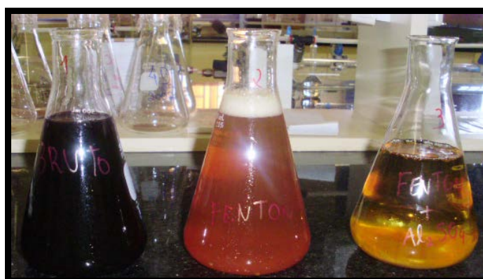
Figura 3: A direita lixiviado bruto; centro lixiviado após processo de coagulação; Esquerda lixiviado após processo foto-fenton.
