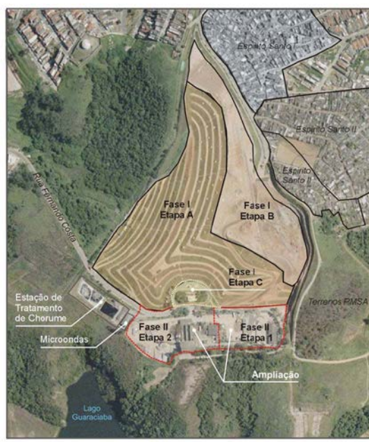
Figura 9: imagem aérea das fases de ampliação do Aterro Sanitário
