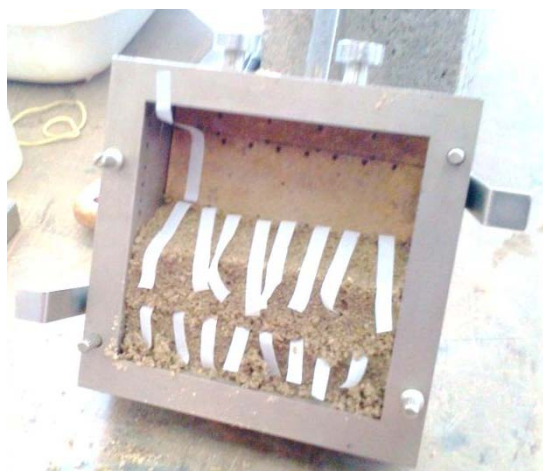
Figura 4: Vista da montagem do corpo de prova e do posicionamento das tiras plásticas. As fibras plásticas foram imersas no chorume durante 2, 4 e 6 semanas, conforme Figura 5.
