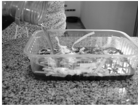
Figura 5: Imersão das fibras plásticas no chorume.
